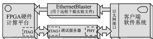
图 1 远程教学实验系统的总体结构图
